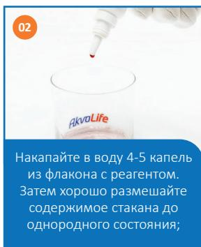
Накапайте в воду 4-5 капель из флакона с реагентом. Затем хорошо размешайте содержимое стакана до однородного состояния;
