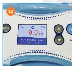
Через несколько секунд на дисплее отобразится последний выбранный уровень pH (к примеру pH 9.0). Установленный уровень pH запоминается прибором и может быть использован в следующий раз. Достаточно нажать на кнопку «START/STOP», чтобы приготовить воду с тем же уровнем, что и в прошлый раз.
