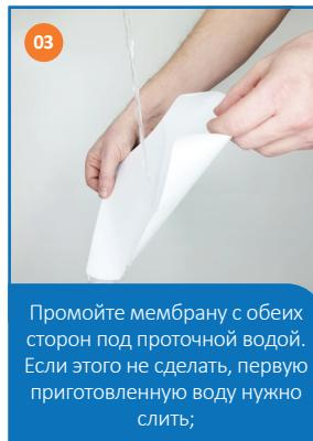
Промойте мембрану с обеих сторон под проточной водой. Если этого не сделать, первую приготовленную воду нужно слить;
