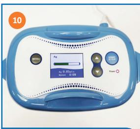
Зеленая полоска показывает ход процесса приготовления воды (процесс серебрения длится от 1 секунды до 200 минут в зависимости от выбранной концентрации);
